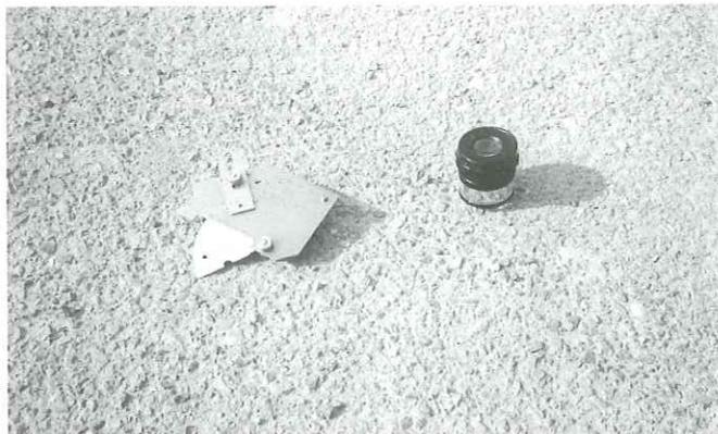
*Detalle del Medidor de Garganta de Soldaduras ("galga") y la Lupa de Inspección. Véase las distintas posiciones que permite la medición de las dimensiones del cordón.*
