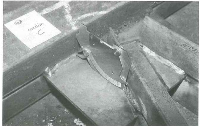
*Aspecto general de un cordón de soldaduras sobre el que se está procediendo a la medición de su profundidad de garganta.*
