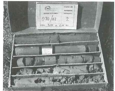
*Detalle de una caja de sondeos donde claramente se aprecia la tipología del terreno y el tubo de Muestra Inalterada.*
