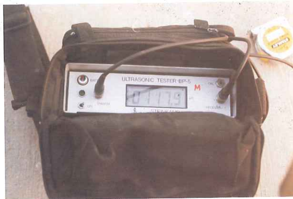
Figura 6.- Detalle de equipo de ensayo de ultrasonidos.
