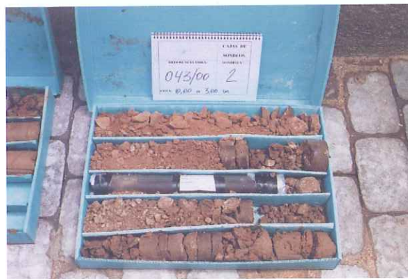
Figura 4.- Caja de muestras del terreno extraídas mediante Sondeo Mecánico para su identificación y transporte al laboratorio de ensayos. Véase una muestra inalterada.
