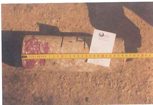
Figura 7.- Comprobación de la velocidad de carbonatación, sobre una probeta de testigo de hormigón.
