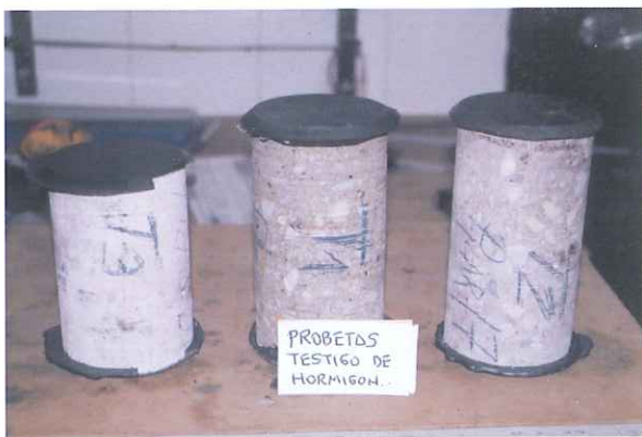
Figura 11.- Tres probetas testigo de hormigón en el laboratorio, convenientemente refrentadas, preparadas para su posterior ensayo a compresión simple.
