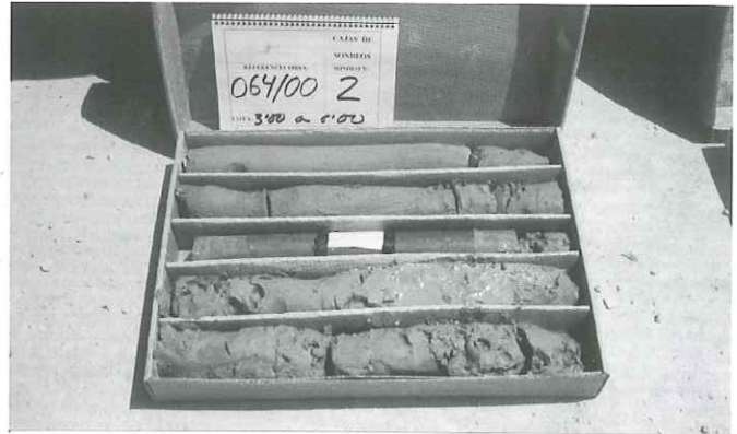
Imagen de una caja de muestras de sondeos donde se observa el material extraído. Véase las muestras del terreno y su aspecto, así como la muestra inalterada (M.I.), en su tubo toma-muestras de P.V.C., herméticamente cerrado.
