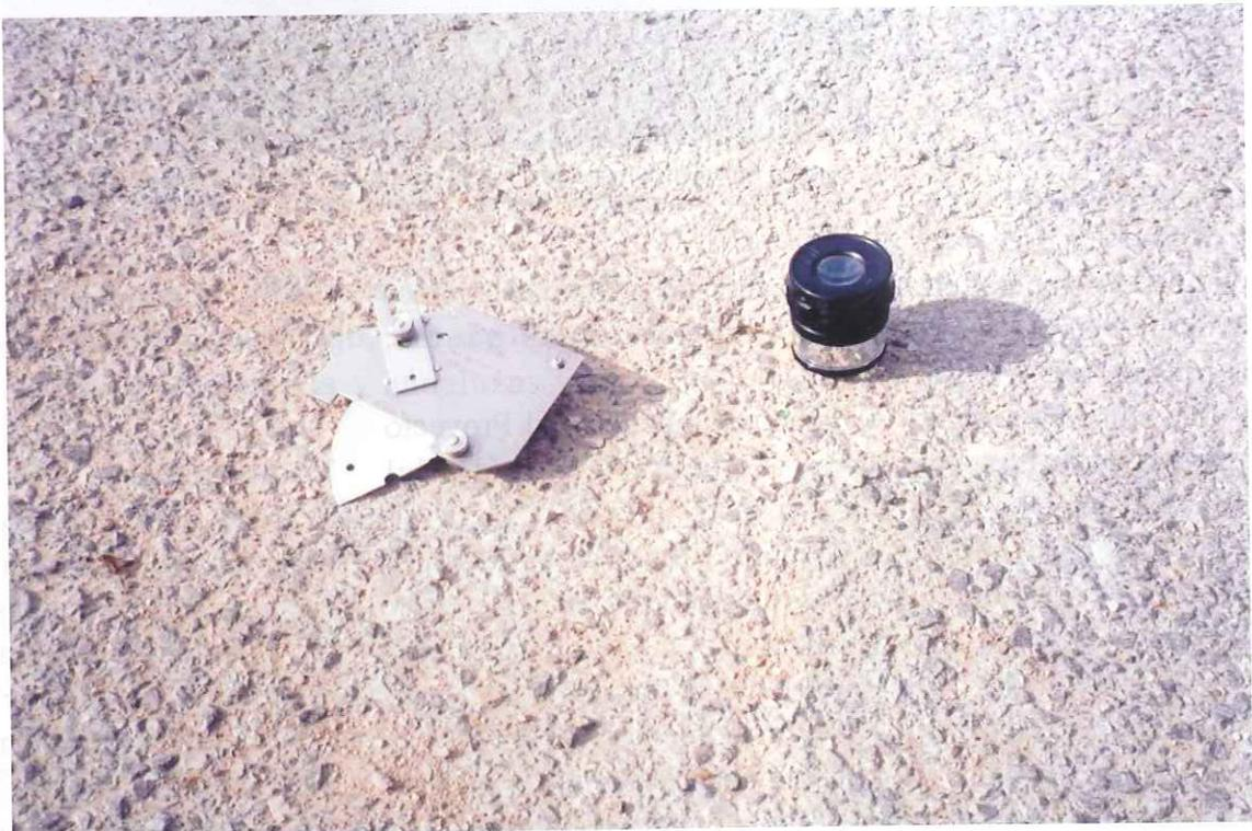
Detalle del Medidor de Garganta de Soldaduras ("galga") y la Lupa de Inspección. Véase las distintas posiciones que permite la medición de las dimensiones del cordón
