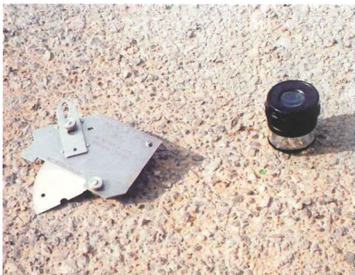
Detalle del Medidor de Garganta de Soldaduras ("galga") y la Lupa de Inspección. Véase las distintas posiciones que permite la medición de las dimensiones del cordón.
