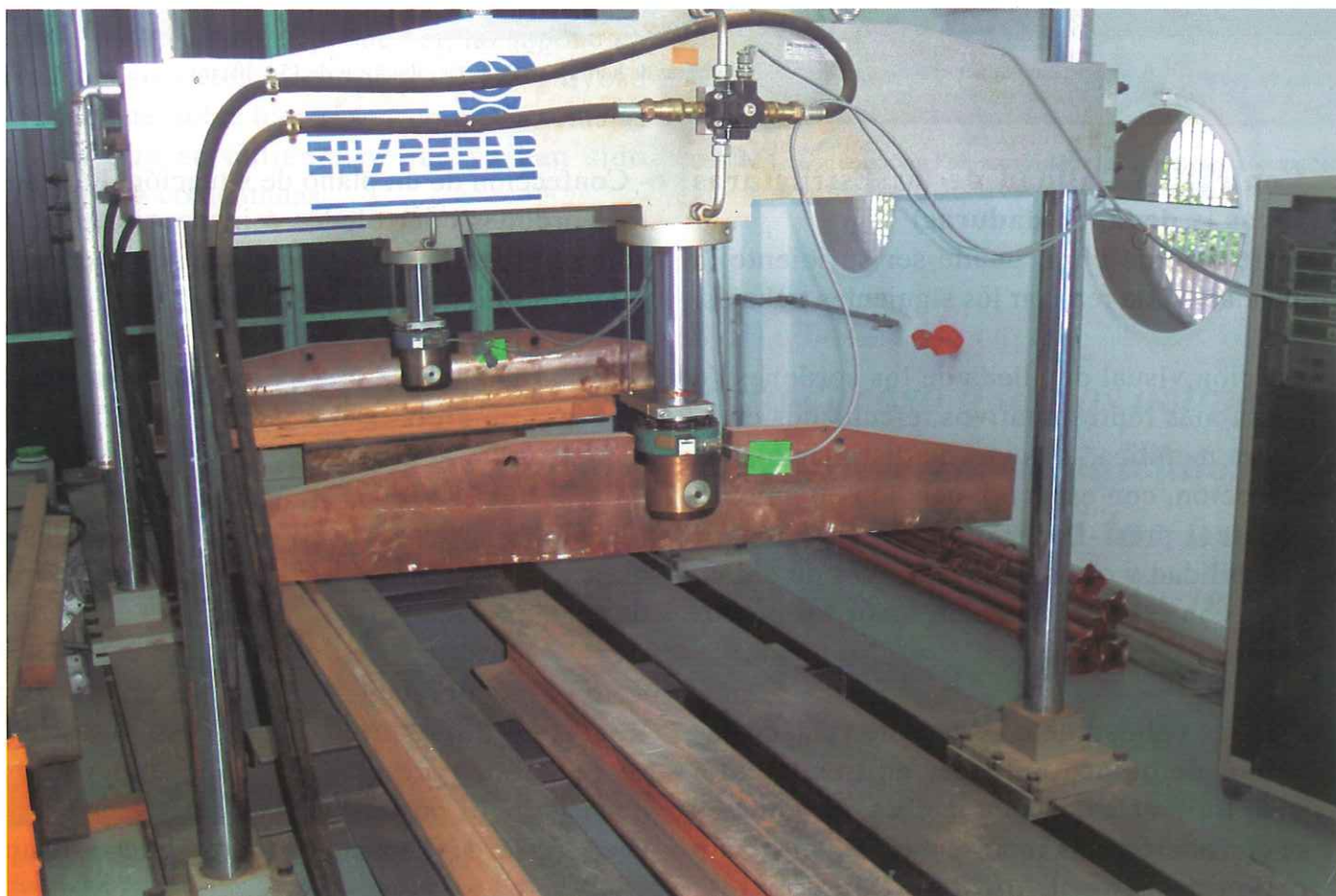
Proceso de ensayo a flexión de vigas metálicas, para comprobar también su comportamiento deformacional.
