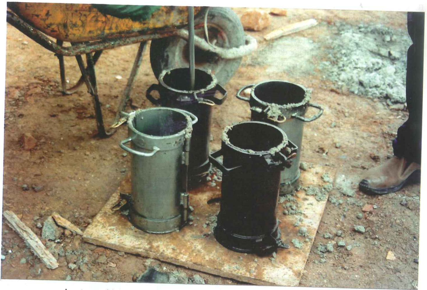
Aspecto general de los moldes para toma de muestras de hormigón (Probetas cilíndricas de 15 x 30 cm).
