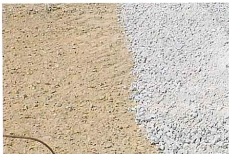
Detalle de la comprobación de la tipología de las distintas zahorras, utilizadas para la formación de base y subbase de la solera de hormigón de una Nave Industrial
