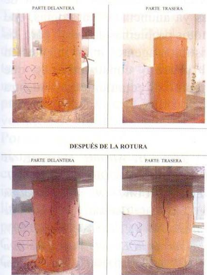
Las muestras del terreno, adecuadamente identificadas, se trasladan al laboratorio para sus correspondientes ensayos de caracterización de los materiales. Véase el proceso de un ensayo a compresión de una muestra de terreno, para la obtención de la tensión admisible del terreno, para el cálculo y dimensionado de las cimentaciones
