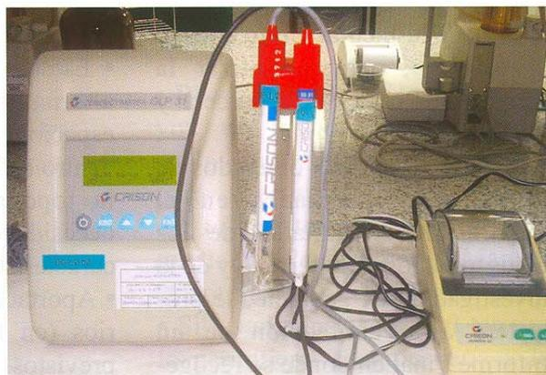
Ensayos complementarios que se realizan a las muestras del terreno, tomadas “in situ” del fondo de las catas de inspección o del interior de los sondeos mecánicos que puedan ser llevados a cabo (Conductividad, pH, etc.)
