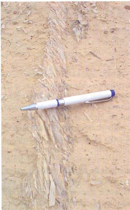
Se analizan "in situ" los detalles mas significativos de la tipología de los terrenos investigados. Véase una muestra que claramente pone de manifiesto la presencia de yesos en el terreno y por tanto, la recomendación de uso de cementos sulforresistentes, como medida de protección del hormigón armado de las cimentaciones de las futuras Naves Industriales, de cara a la protección de sus armaduras y prolongar así su vida útil
