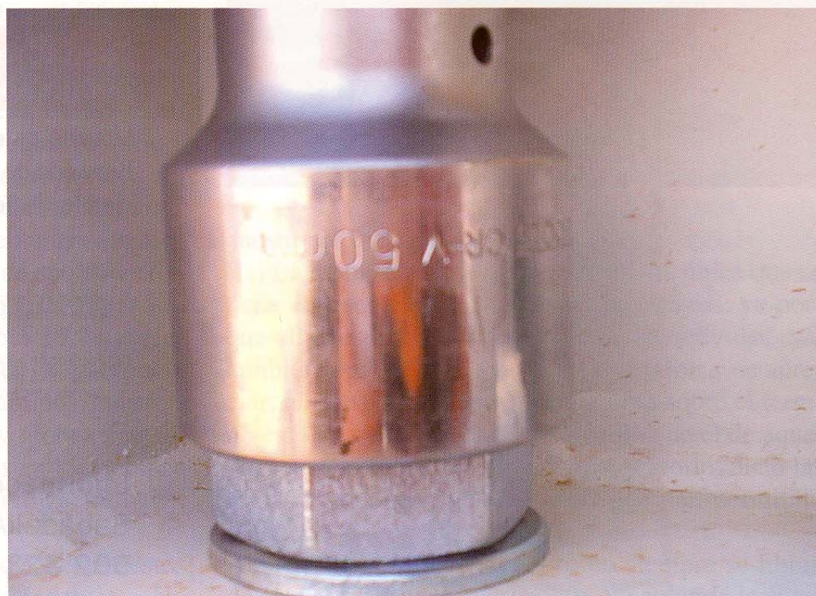
Detalle del equipo utilizado para proporcionar el primer apriete de la tornillería, para las puntas de unión de la estructura
