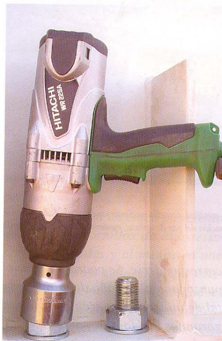
Aspecto del equipo mecánico para el primer apriete de la tornillería, de una estructura metálica cuyos nudos están resueltos mediante uniones atornilladas
