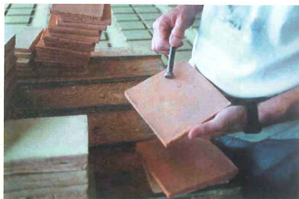
Control de calidad: Prueba de sonido
