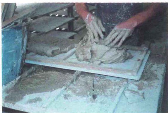
Vertido del barro sobre el marco de madera
