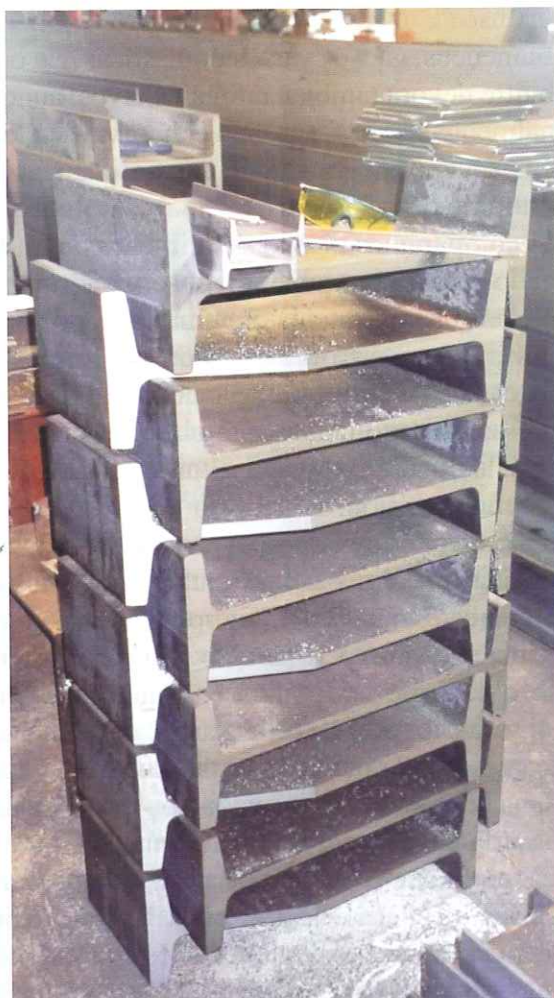
Acopio de material en taller, para confeccionar distintos elementos estructurales, que se van a resolver mediante uniones soldadas
