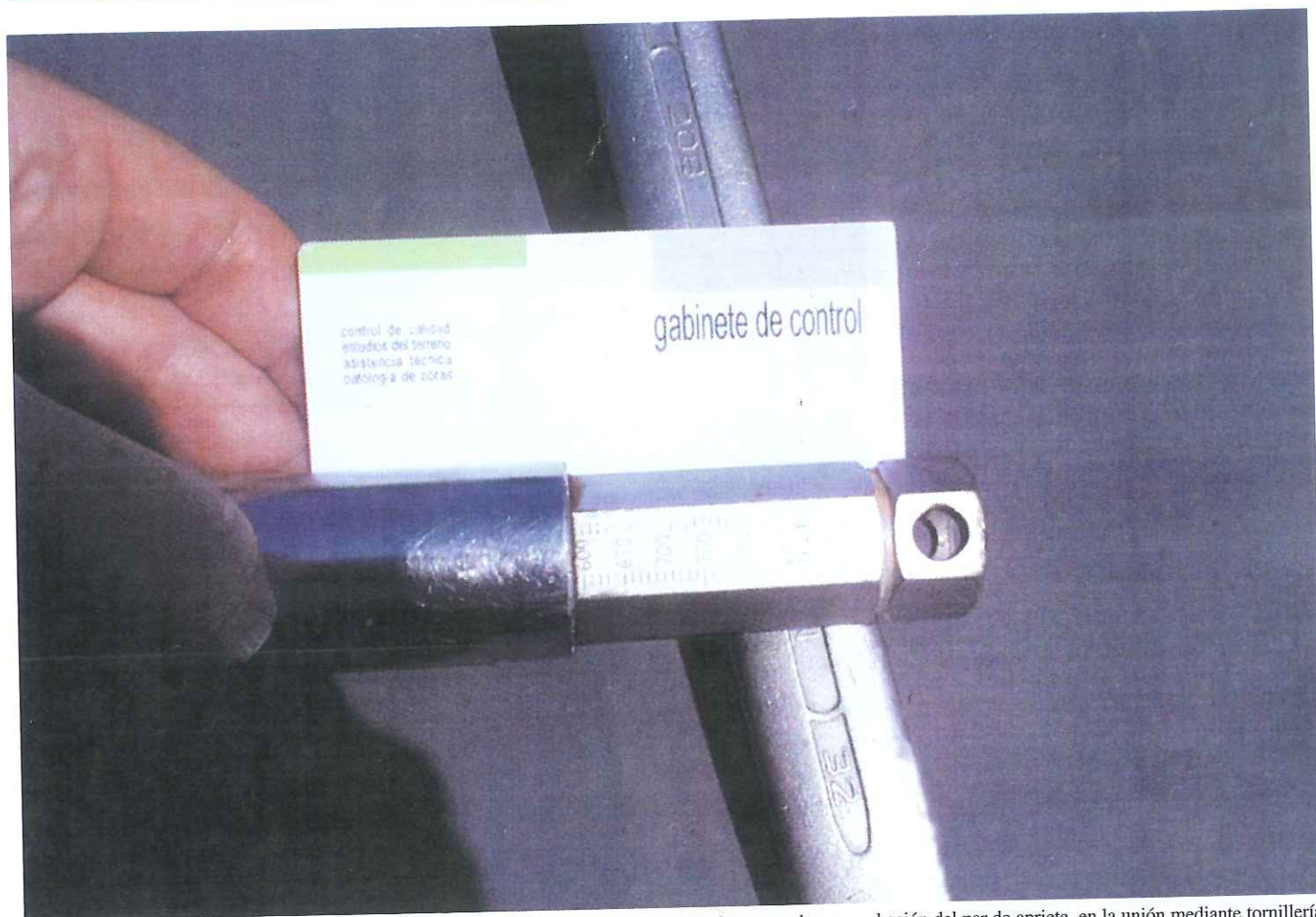
Detalle de la marca graduada de la llave dinamométrica, durante el proceso de comprobación del par de apriete, en la unión mediante tornillería
