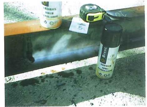
Detalle del resultado de la aplicación del líquido penetrante revelador, donde se observan los defectos detectados
