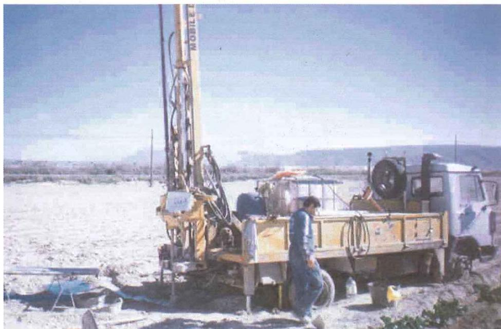
Vista general del equipo de sondeos durante la realización de los trabajos de perforación y toma de muestra del terreno donde se emplazará la futura Nave Industrial.
