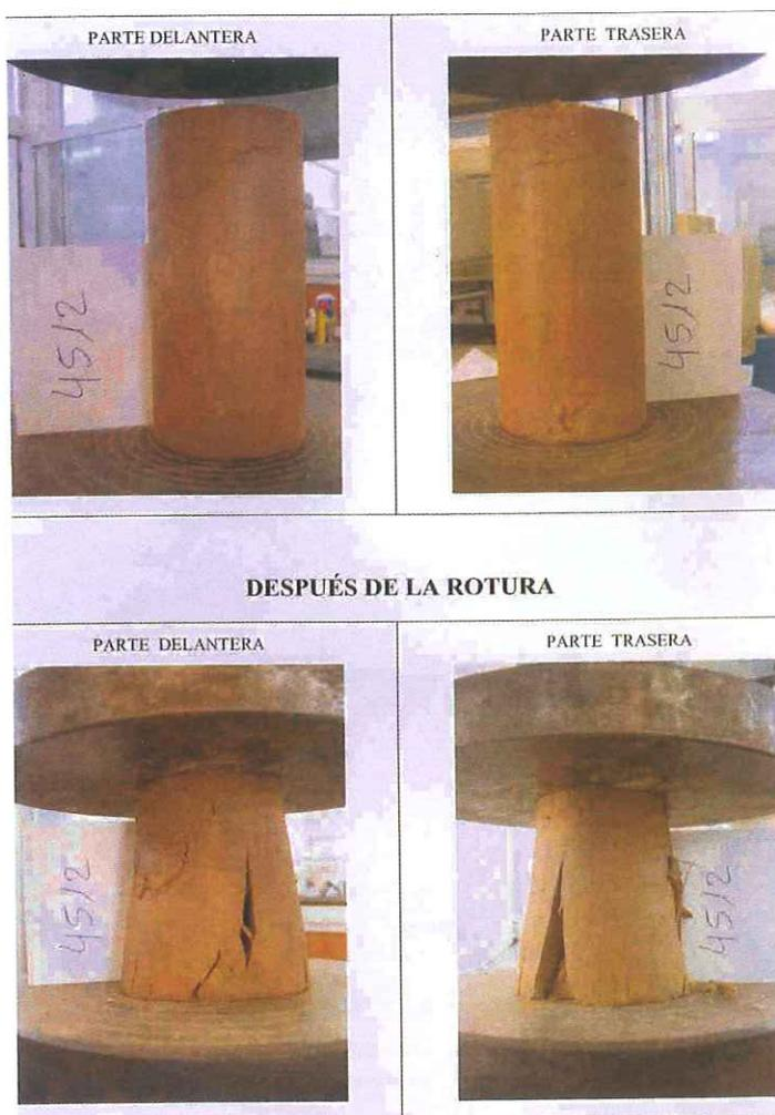
Detalle del proceso de ensayo de Muestra Inalterada del terreno, realizada por Laboratorio Acreditado.
