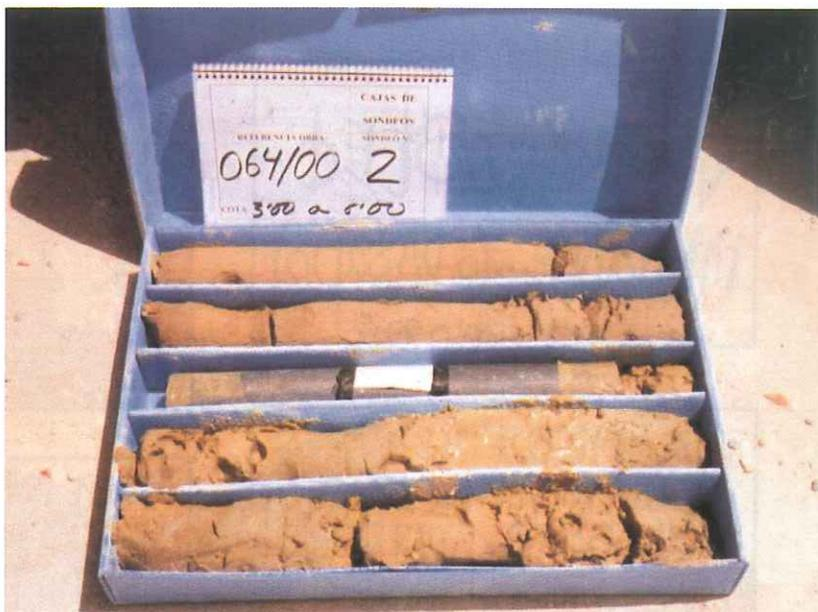
Imagen de una caja de muestras de sondeos donde se observa el material extraído. Véanse las muestras del terreno y su aspecto, así como la muestra inalterada (M.I.), en su tubo tomamuestras de P.V.C., herméticamente cerrado, para su transporte al laboratorio.
